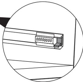
E1. スライドレールの可動部を全て手前側に移動させた状態で引出しを差し込んでください。
