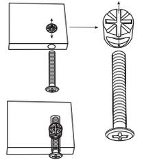
ボルトに対してネジ穴がまっすぐになる用、ドライバーで調節してください。
