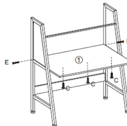
C.ボルト(最短) (M6 × 25mm) × 3      E.ボルト(中) (ST6 × 45mm) × 2
