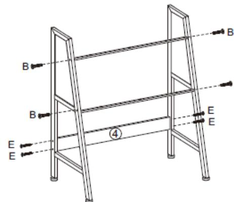
B.ボルト(短) (M6 × 30mm) × 4      E.ボルト(中) (ST6 × 45mm) × 4
