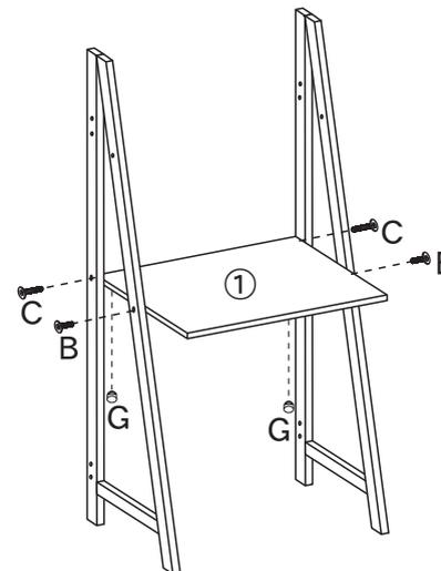
棚受けネジはドライバー用の溝が表面側になるように取り付けてください。
