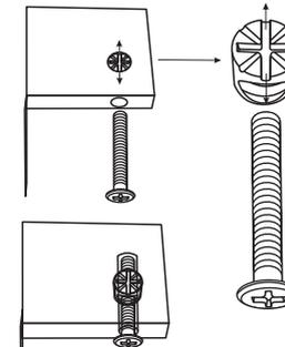
ボルトに対してネジ穴がまっすぐになる用、ドライバーで調節してください。
