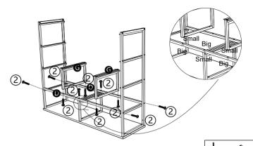
2 穴バー E を取付ける向きは、大きい穴が 上面になるように取付けてください。タテ フレームGを取付ける時は、ストッパー部 分がすべて同じ側になるように取付けてく
