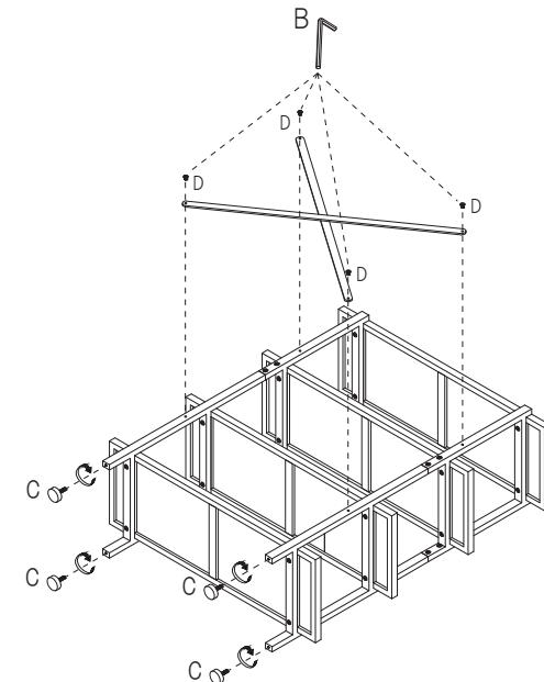
**8** **2**、**3**、**4**、**5**、**6**で仮止めになっていた、各ボルトをB六角レンチとGスパナを使って最後まで締めて下さい。次に商品をゆっくりと起こして下さい。
