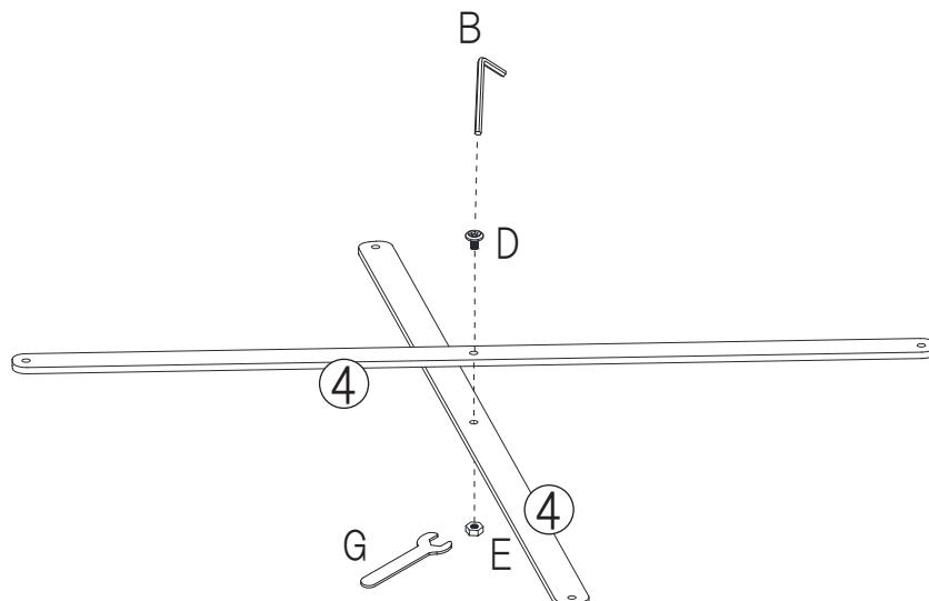
**7** **6**で組立てた部材を、下記イラストの様に、**5**で組立てた部材に、DボルトとB六角レンチで取り付けて下さい。次に、Cアジャスターをフレームの脚に取り付けて下さい。
