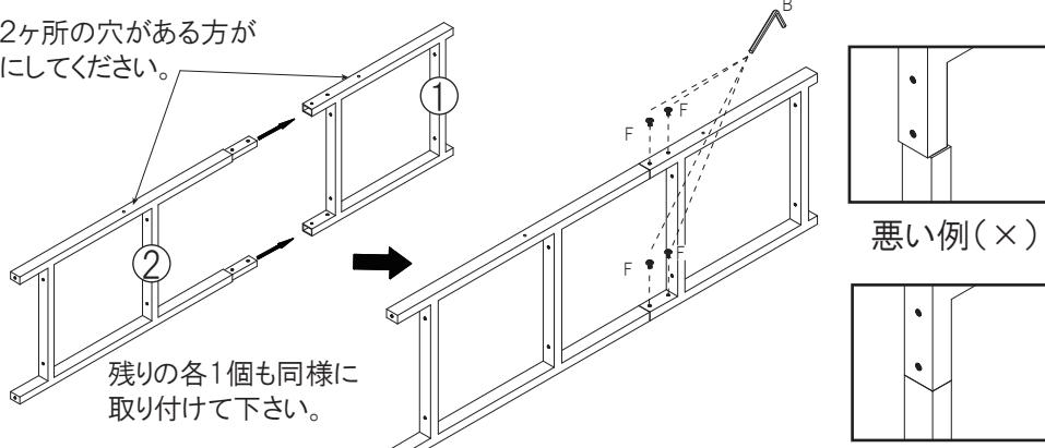
①上フレームと、②下フレームはスムーズに組立ができるように、挿し込み部分にあそびの隙間
