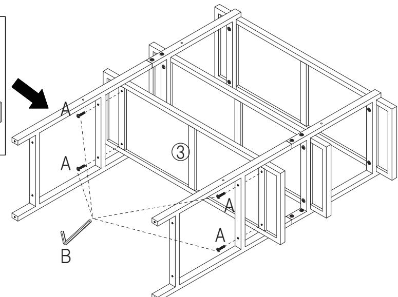
**5** **4**で組立てた部材を、下記イラストの様に、③棚板を横から入れて、AボルトとB六角レンチを使用して、取り付けて下さい。
