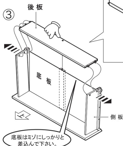
後板が入るように左右の側板を少し広げ、後板のミゾに底板を差込みながら後板の穴を補強棧に合わせて押込みます。(側板は必要以上に広げすぎないように、注意して下さい)
