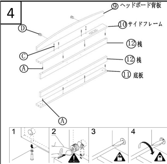
ヘッドボードのパーツを作成します。
