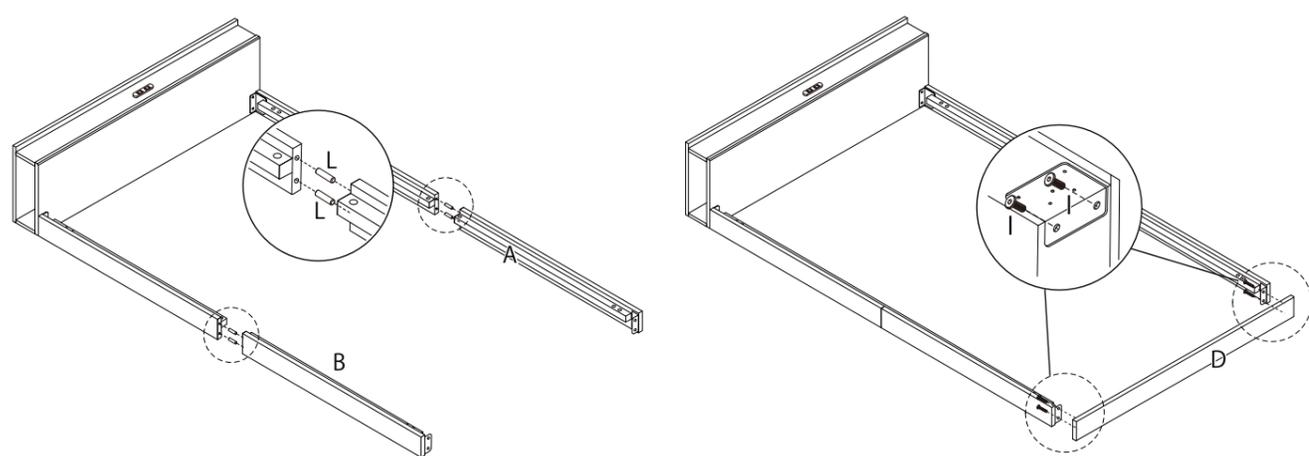
**3** 図のようにCの支え板をAとBのサイドフレームの穴に位置にJのボルトで仮止め、Kの六角レンチで締めます。その後、Fの支え棒のネジとCの支え板の穴の位置を合わせ、Jのボルトで取り付けます。
