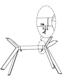
手順2で組んだ脚部分とC天板をDネジとF六角レンチで取り付けます。 Dネジはこの時完全に締め切ってください。
