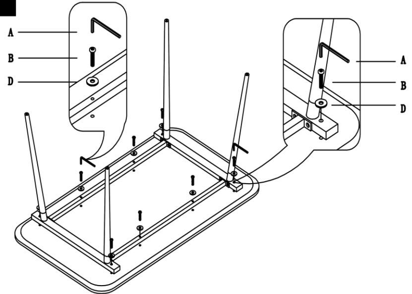
②テーブル天板を裏返し、初めに固定した脚部と中棧を部品A・B・Dを使用し、天板裏側に固定してください。
