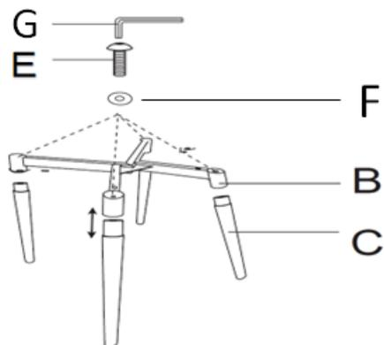
部品B脚フレームに部品C脚を部品Eボルト（短）・F・Gを使って取り付けます。
