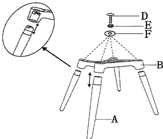
**2** C座部裏面へ脚Bを図のようにのせて、Gボルト（短）とHワッシャー（小）を使用して固定します。
