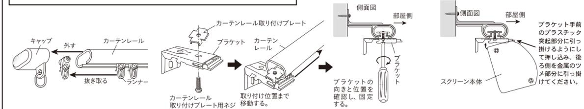
① カーテンレールのキャップを外し、ランナーを抜き取ってください。
